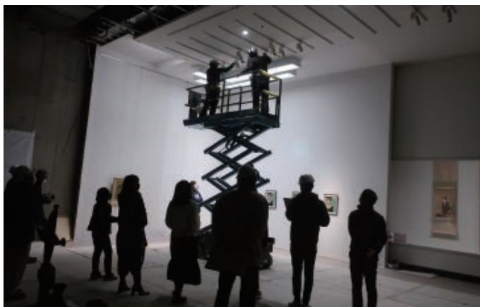
挿図15 現・ギャラリー1におけるモックアップでのスポットライト照明実験
